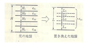
図のように、圧密係数  $c_v$  と層厚 H が異なる n 層からなる粘土層がある。この粘土層を圧密係数  $c_v$ 0 を有する厚さ L の 1 層系の地盤に置き換える。
