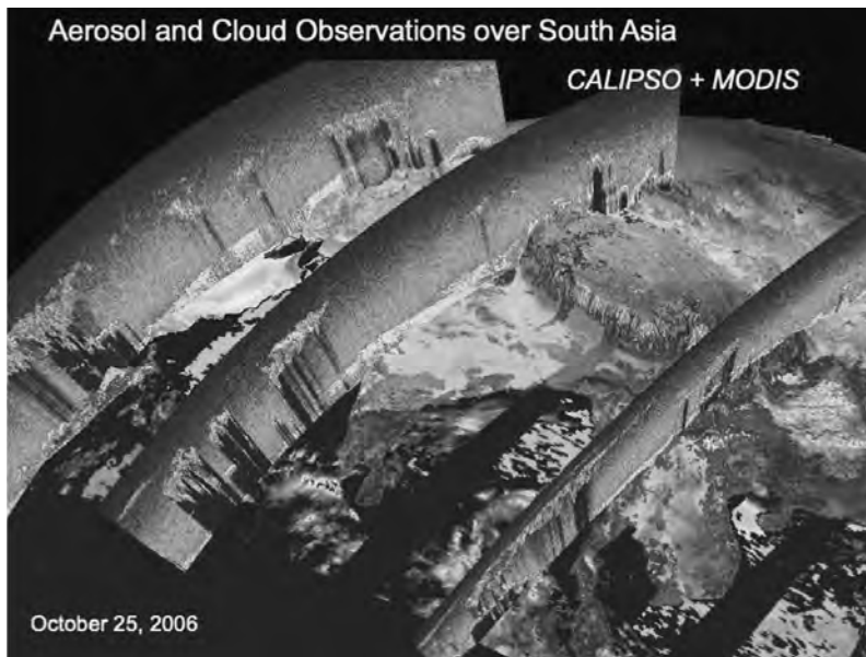
図 2.6 南アジア域におけるエアロゾルと雲の 3 次元分布。MODIS センサによるエアロゾル光学的厚さの水平分布と CALIPSO ライダーによるエアロゾルのライダーエコー信号の高度分布を合成した図。ヒマラヤからインド域にかけて発達する人為起源エアロゾル層の分布状態がわかる 22) (提供：NASA)
