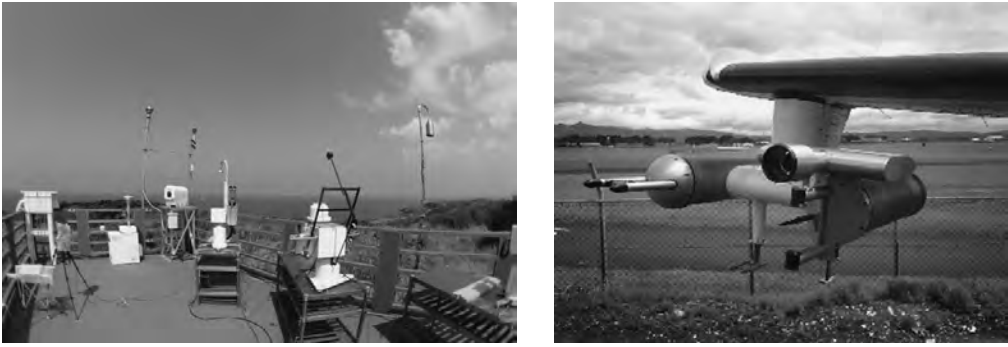
図 2.2 沖縄県辺戸岬地上検証拠点（左図），航空機の翼先端に取り付けられた雲測定器（右図） （提供：中島孝（東海大））
