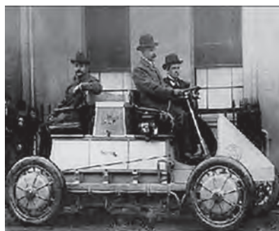
図 1-5 1900 年独 Lohner-Porsche 車 パリ万博にて（インホイール モータによく似たモータ構造）
