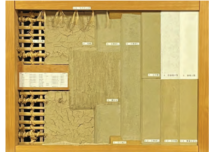
土壁の塗工程
